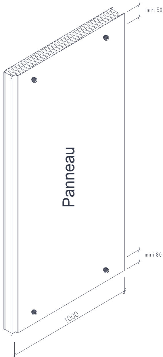
Figure 3 bis - Positionnement des fixations traversantes sur une largeur du panneau (exemple : largeur 1000 mm) hors zone sismique
